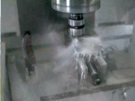
Trabajo normal con refrigerantes
